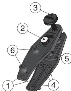
Der Axtkopf muss mit allen sechs **Gummiprofilen** in Kontakt sein, wenn die **Schraube** und der **Knopf** angezogen sind, um in der Vorrichtung fest zu sitzen.
