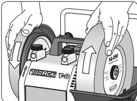
Drehe die Schleifscheibe von Hand nach rechts, während du die Abziehscheibe festhältst. Die EzyLock-Mutter löst sich automatisch.
