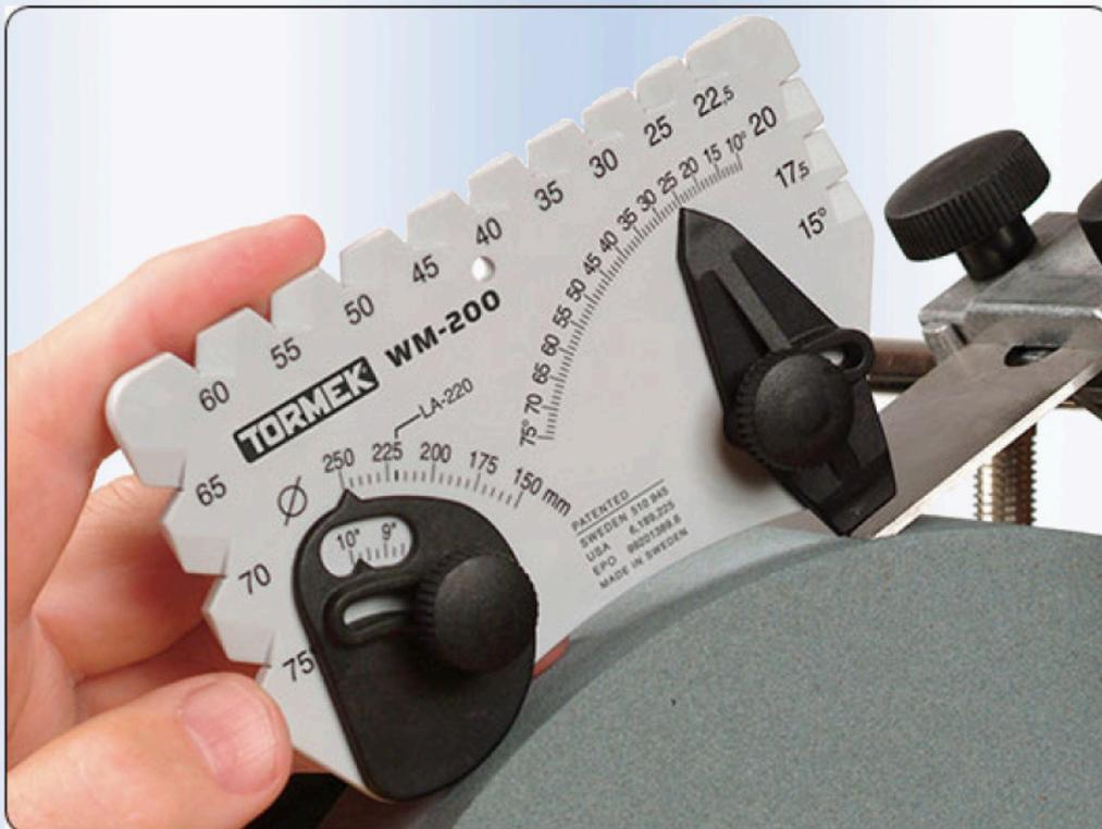
Diese patentierte Winkellehre hat zwei Funktionen. Sie kann für die Einstellung der Vorrichtung zum Schleifstein verwendet werden, um Werkzeuge mit wahlfreiem Schneidenwinkel von 15° bis 75° zu schleifen. Sie kann ebenfalls für die Messung eines vorhandenen Schneidenwinkels bei einem Werkzeug verwendet werden.
