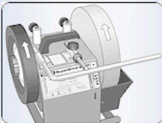
Horizontal für Schleifen mit der Schneide.
