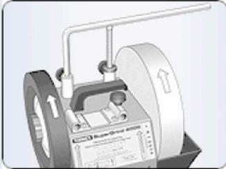
Vertikal in den beiden Führungsbuchsen. Beim Schleifen gegen die Schneide.
