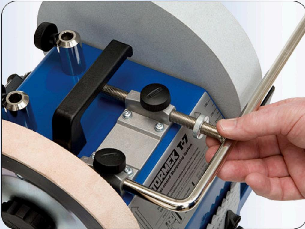
Die vielseitige Universalstütze ist die Basis des Tormek Systems. Sie besteht aus 12 mm Rundstahl und wird für höchste Stabilität in doppelte Führungsbuchsen montiert. Die Universalstütze ist mit einer Feinjustierung, für schnelle und genaue Einstellung ausgestattet.\*
