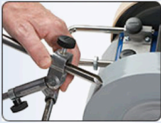
Vorrichtung für Röhren SVD-185
