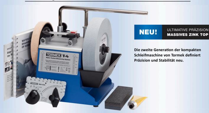
Die TORMEK T-4 ist eine Weiterentwicklung des Modells T-3 welche Präzision und Stabilität auf ein völlig neues Niveau bringt. Vertikal- sowie Horizontalhalter für die Universalstütze und der integrierte Tragegriff sind in einem einzigen Stück aus Zinkguss gefertigt. Motor und Hauptwelle sind am gegossenem Oberteil montiert und bilden dadurch eine solide Einheit. Durch diese massive Bauweise wurde die Genauigkeit beim Schärfen deutlich verbessert.
