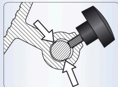
*In der patentierten Konstruktion wirken die Anpresskräfte von beiden Seiten und nicht von vorne. Das bedeutet, dass die Blockierkraft sich um ganze 250% erhöht.*
