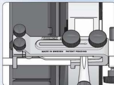
Richten Sie das Werkzeug mit Hilfe der Linie auf.
