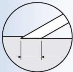
Länge des Halts bei einfacher Schleiffase.
