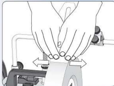
Den Steinpräparierer mit der feinen Seite 45–60 Sekunden gegen den Schleifstein drücken. Drücken Sie relativ hart.
