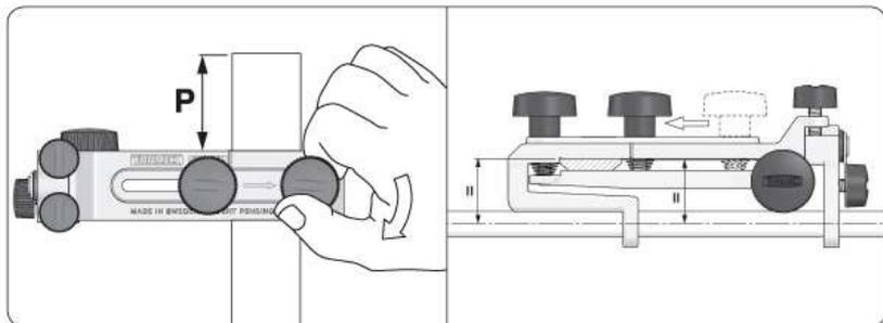
Montieren Sie das Werkzeug (P) mit 50–75 mm Überstand. Fixieren Sie das Werkzeug in der Vorrichtung indem Sie die bewegliche Schraube ca. 5 mm vom Werkzeug anziehen.
