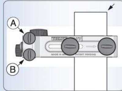
Um den Schleifdruck auf der rechten Seite zu erhöhen, lösen Sie A und ziehen Sie B an. Machen Sie das Gleiche entgegengesetzt um den Schleifdruck auf der linken Seite zu erhöhen. Justieren Sie ca. ¼ Drehung bis Sie das erwünschte Resultat erhalten.
