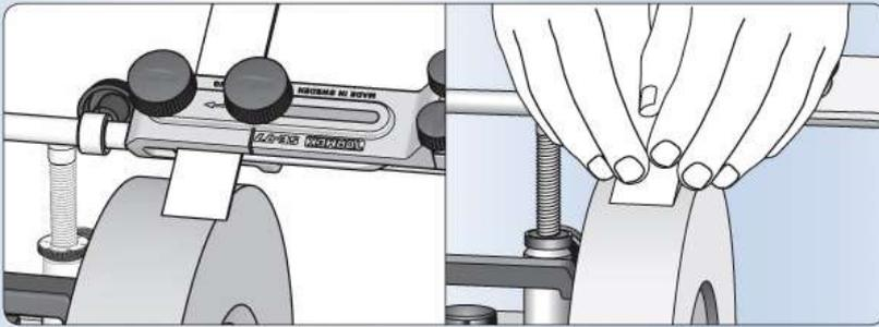
Versetzen Sie das Werkzeug, damit die ganze Breite des Schleifsteins ausgenutzt wird. Lassen Sie es höchstens ca. 2 mm außerhalb der Steinseite kommen. Ein fester Schleifdruck ergibt einen schnelleren Schleifvorgang. Den Druck am Ende des Schleifens verringern; dann erhalten Sie eine feinere Schleiffläche.
