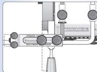
Die Sicherheitsanschlüge werden beim Abziehen nicht benutzt. Achten Sie deshalb darauf, dass Sie das Werkzeug nicht zu weit seitlich führen. Ein Teil des Werkzeugs muss immer mit der Abziehscheibe in Kontakt sein.
