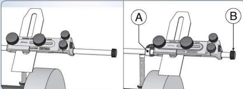
Den inneren verstellbaren Anschlag (A) so anbringen, dass das Werkzeug etwa 6 mm auf dem Stein liegt. Montieren Sie dann den aueren Anschlag (B), der fest und von Werkzeugbreite unabhangig ist.
