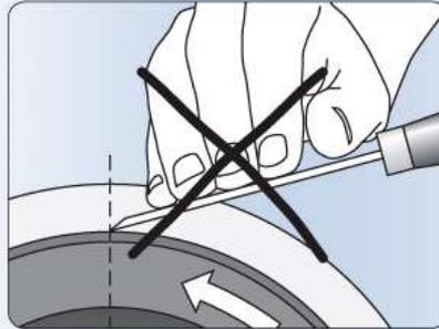
Das Werkzeug nicht in steilerem Winkel als die Tangente halten, sonst wird die Spitze abgerundet.
