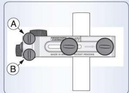
Lösen gleichmässig die Justierschrauben A und B. Die Seite beginnt zu pendeln. Je mehr Sie die Schrauben lösen, desto stärker wird die Pendelbewegung, welche die Konvexität verstärkt.
