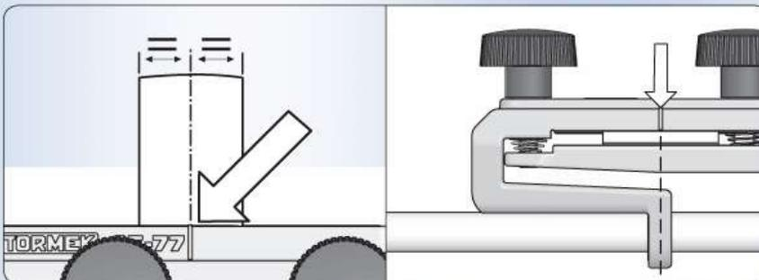
Zentrieren Sie das Werkzeug unter dem Drehpunkt der Vorrichtung, markiert mit einer Linie. Stellen Sie sicher dass das Werkzeug rechtwinklig montiert wird, mit Hilfe einer gezeichneten Linie entlang der Universalstütze (Seite 126).
