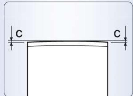
Die Konvexität wird erzielt, indem Sie fester auf die Seiten Druck ausüben. Wenn Sie das Eisen mit einem längeren Überstand montieren, geht dies leichter, da die meisten Hobeisen nicht gänzlich steif sind. Auf einem starken und steifen Eisen erzielen Sie die konvexe Form einfach durch ein längeres Schleifen auf den Seiten.
