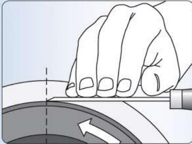
Ziehen Sie die Spiegelseite freihändig ab. Halten Sie das Werkzeug wie eine Tangente zur Abziehscheibe.
