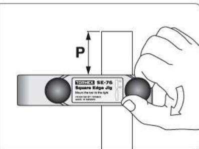
Die Schließplatte nach der Dicke des Werkzeugs und parallel mit der Basis einstellen. Das Werkzeug mit 50–75 mm Überstand (P) montieren. Festziehen, aber nur mit der Schraube, die dem Werkzeug am nächsten ist.
