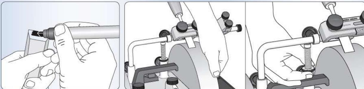
Die Schleiffase mit einem Filzschreiber einfarben. Drehen Sie den Stein von Hand. Justieren Sie die Hohe der Universalstutze mit der Feinjustierung, bis der Stein auf die ganze Schleiffase von hinten bis vorne trifft.
