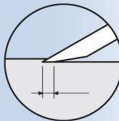
Verringerter Halt mit zusätzlicher Schleiffase bei einem Stechbeitel.
