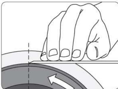
Ziehen und polieren Sie freihändig auf der Abziehscheibe ab. Halten Sie das Werkzeug wie eine Tangente zur Abziehscheibe.
