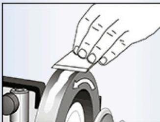
Schalten Sie die Maschine ein und verteilen Sie die Abziehpaste durch leichten Druck mit dem Werkzeug auf die Scheibe.
