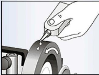
Das Leder einer neuen Abziehscheibe mit dünnem Maschinenöl imprägnieren. Hierdurch wird das Leder weicher und die Abziehpaste kann besser eindringen.
