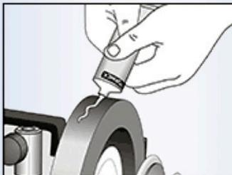
Tragen Sie eine dünne Schicht Abziehpaste auf, bevor Sie die Maschine einschalten. Die Abziehscheibe dabei von Hand drehen.
