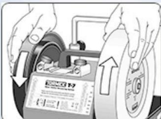
Ausbau: Halten Sie die Lederabziehscheibe mit einer Hand fest und drehen Sie dann den Schleifstein im Uhrzeigersinn mit der anderen Hand. Die EzyLock-Mutter löst sich dadurch automatisch.
